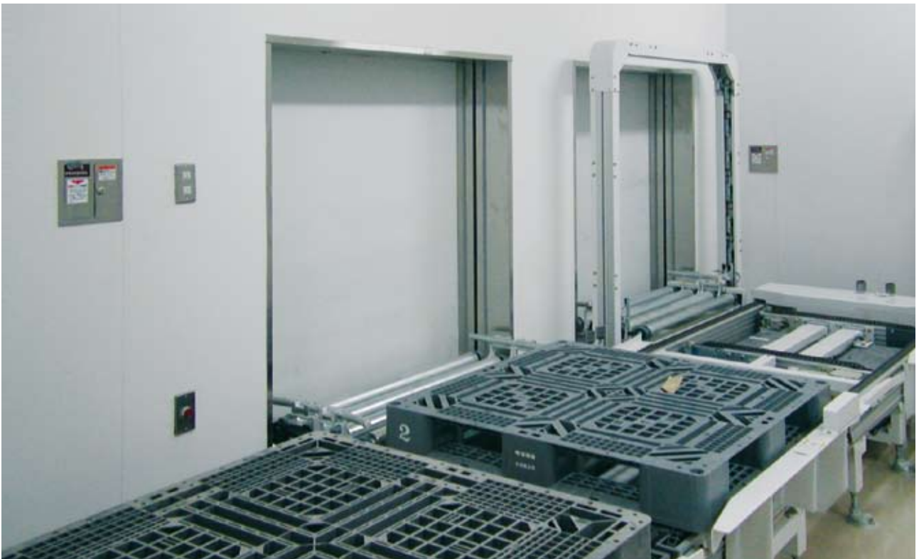
La puerta SRT-CR integrada con una cinta transportadora.
